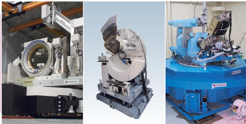
X선 회절계는 단색의 X선을 시료에 맞춰 그 회절 강도를 측정하여 시료의 결정구조를 결정하는 장치입니다. 코우즈세이키는 1990년에 오더 메이드로 제조한 κ(코퍼) 고니오 미터 방식의 회절계를 시작으로 일본의 SPring-8, 독일의 DESY Petra-III, 영국의 다이아몬드 등의 방사광 시설과 미국의 NASA 등 해외의 연구소에 수많은 오더메이드 회절계를 제공해 왔습니다. 이러한 많은 경험은 다축형 단결정 회절계 NZD시리즈와 다연장 분말 회절계 PDS시리즈 등으로 결실을 맺었습니다.
