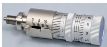
정밀 포지셔너는 정밀 위치결정용으로 개발된 액추에이터입니다. 보내기 방식은 연삭나사를 이용한 조동과 탄성 힌지를 이용한 미동으로 구성되어 있습니다. 탄성 힌지 구조의 채용으로 나사의 맞물림에 의한 백래쉬를 없애고 50nm정도의 감도로 위치결정 조정이 가능합니다. (상세한 것은 O-008페이지)
