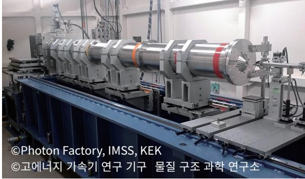
본 장치는 방사광을 측정시료에 조사했을 때, 광축방향에 대하여 수 미리 래디언 정도의 이각(離角)방향으로 나타나는 소위 소각산란(SAXS) X선 신호를 높은 각도 정밀도로 측정 가능하게 하는 장치입니다. 본 장치는 방사광 시설인 KEK PF (Photon Factory)의 BL-15A2빔 라인에 설치되어 있습니다.
