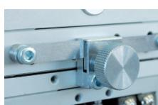
스테인리스 판의 디스크를 2장의 평판 사이에 끼워넣는 타입의 클램프입니다. 클램프시의 위치벗어남을 수μm이하로 억제하였습니다.
