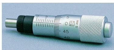
マイクロミ터 헤드는 정밀한 위치결정을 하기 위한 기구로, 연삭가공된 나사와 암나사로 구성되어 있습니다. 슬리브의 눈금과 심볼의 버너어 눈금을 조합하여 10μm 단위까지 위치 확인이 가능합니다.
