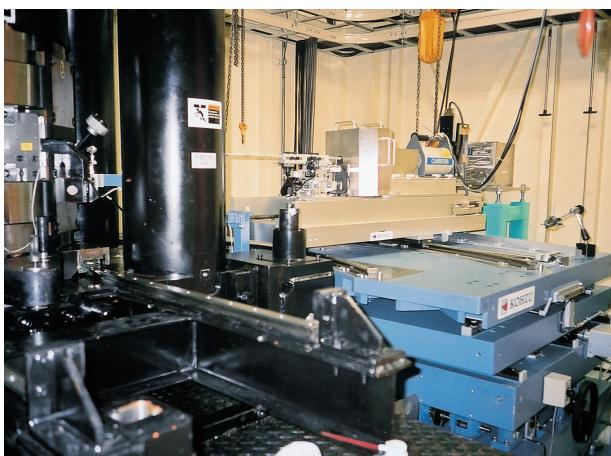
왼쪽의 장치는 고압상태에 놓인 시료의 회절선 에너지 분산법으로 계측하기 위한 스탠드와 위치결정 조정용 장치입니다. 회절선을  $\theta$ - $2\theta$ 의 관계를 지키면서 에너지의 분산법으로 측정 할 수 있습니다. 검출기는 시료를 중심으로 스테이지에 놓이고 그 회전중심 변위량은  $50\mu\text{m}$ 이하입니다. 이 장치는 일본의 방사광 시설인 SPring-8 (Super Photon ring-8 GeV) BL04B2에 납품되었습니다.
